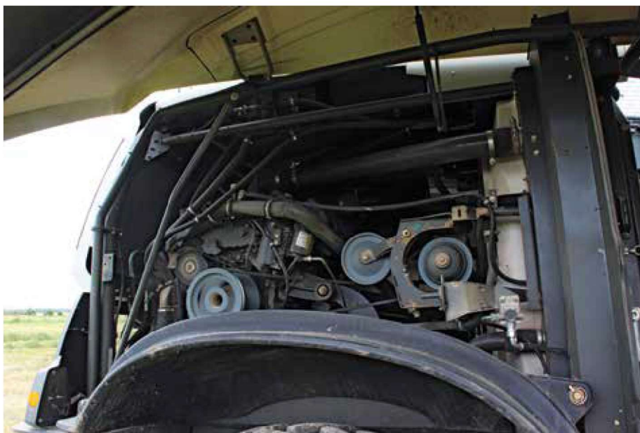
Сердце Claas Jaguar 950 – V-образная восьмерка OM 502 LA от MTU. Двигатель достаточно компактен, а благодаря откидывающимся панелям и быстросъемным крыльям доступ к нему весьма удобен
