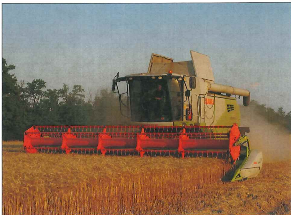
Рисунок 2 – Комбайн зерноуборочный TUCANO 550 с жаткой зерновой CERIO 770 на прямом комбайнировании озимой пшеницы
