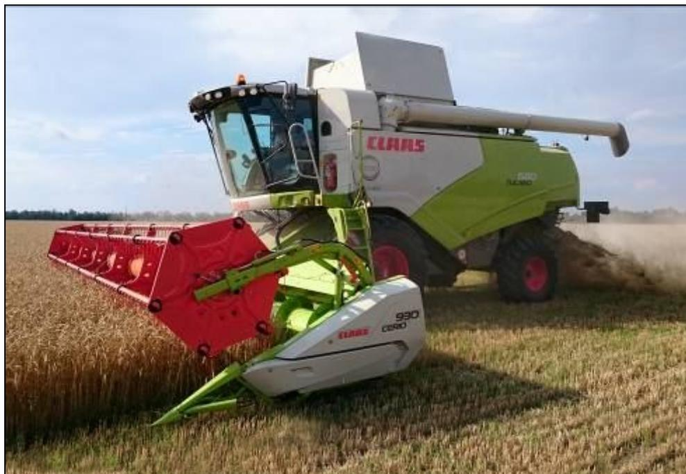
Рисунок 2 – Комбайн зерноуборочный Тисано 580 с жаткой зерновой CERIO 930 на прямом комбайнировании озимой пшеницы
